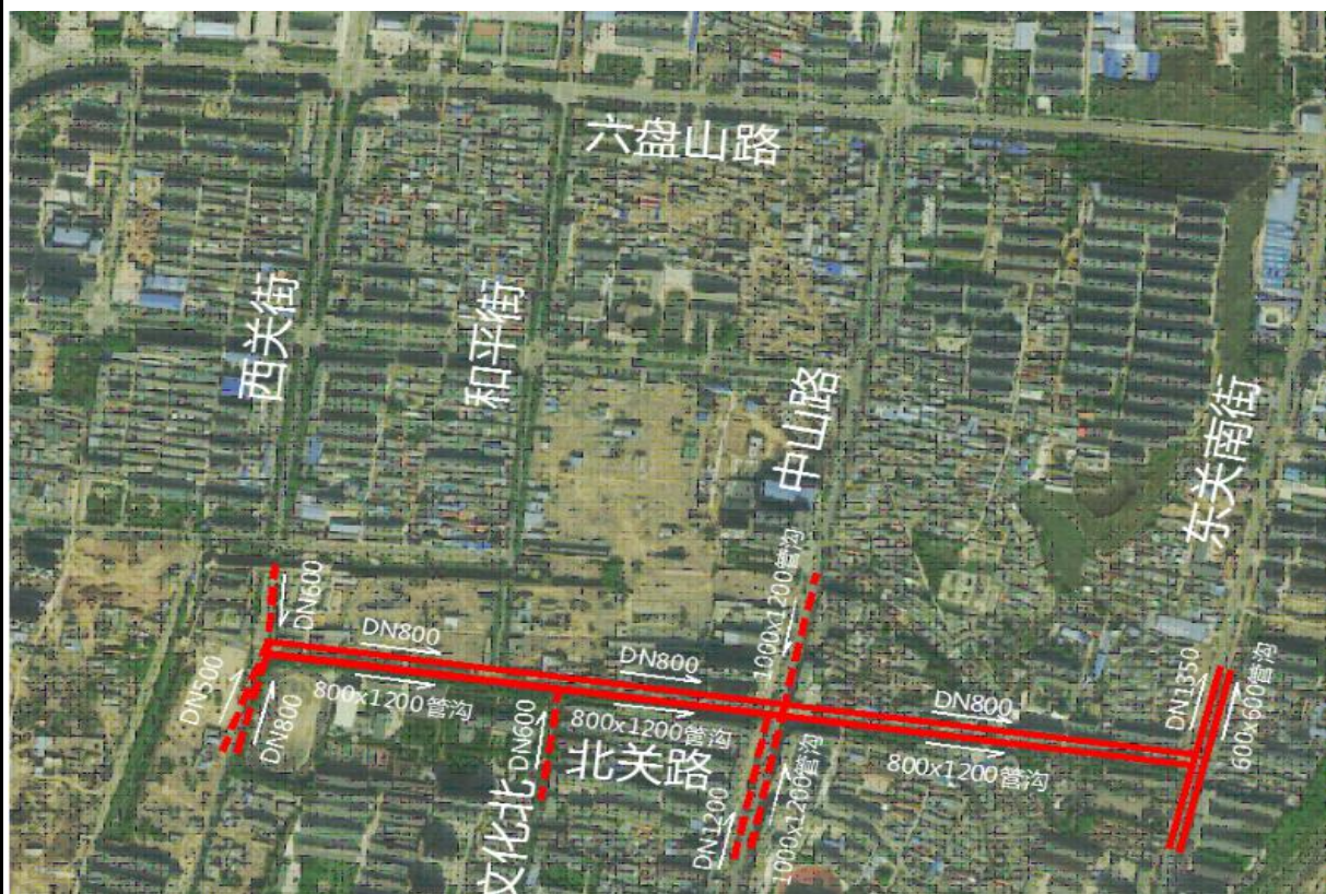
图3 现状道路管径管线及位置示意图
