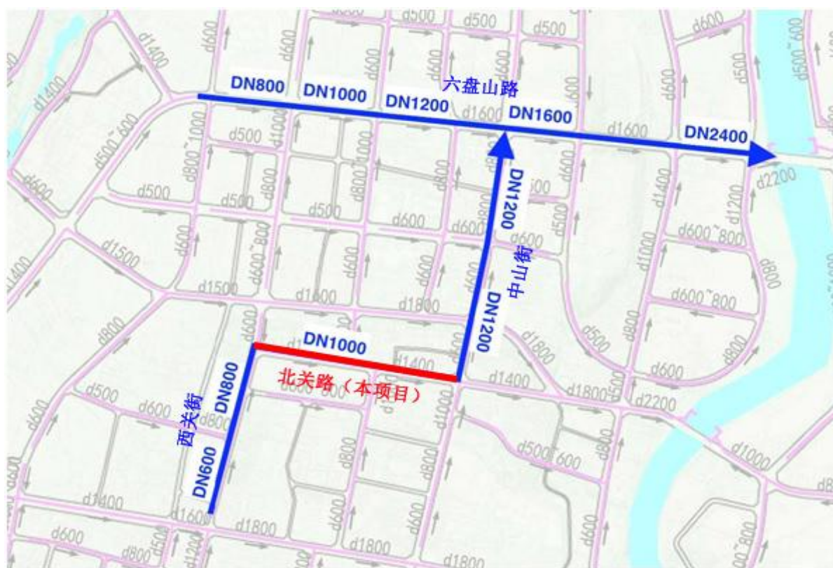
图6 项目区域雨水管道敷设示意图
