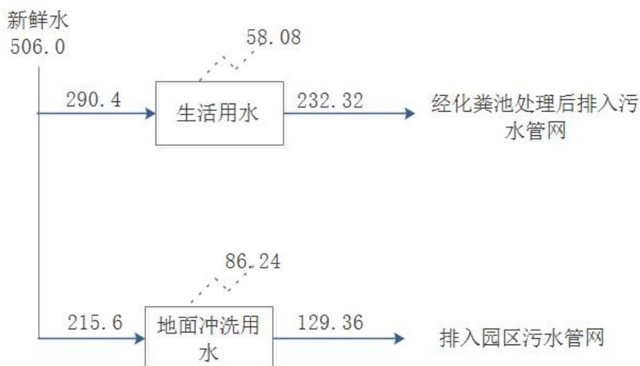
图 2-4 本项目水平衡图 单位：m<sup>3</sup>/a
