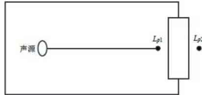
图3 室内声源等效为室外声源图例
